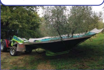
Ombrello con apertura 6,50 mt con collegamento rapido / Standard opening of reverse umbrella 6,50 mtrs with rapid connection
