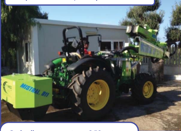
Ombrello con apertura 6,50 mt con collegamento rapido / Standard opening of reverse umbrella 6,50 mtrs with rapid connection
